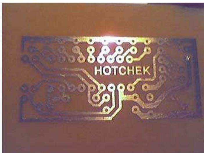
Divirta-se fazendo você mesmo suas placas. Este método é quase tão bom quando mandar fazer a placa em escala industrial, onde é utilizado, geralmente, uma tinta fotossensível para formar o desenho antes da corrosão. Um processo bastante caro... Aproveite, não estou cobrando nada pelas dicas, hehe!!!
