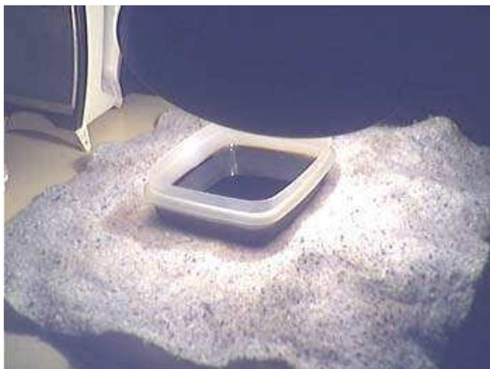
Você pode também, agitar a plaquinha dentro da mistura usando uma pinça de material plástico. Agitar a plaquinha acelera consideravelmente a corrosão.
